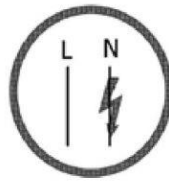
Nole Failure حفاظت قطعی نول یا دو فاز شدن
